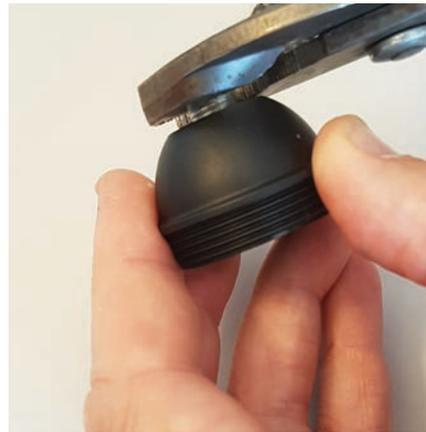
Commencez par visser la tige filetée dans le culot de la douille thermoplastique et serrer à l'aide de la pince multiprise.
